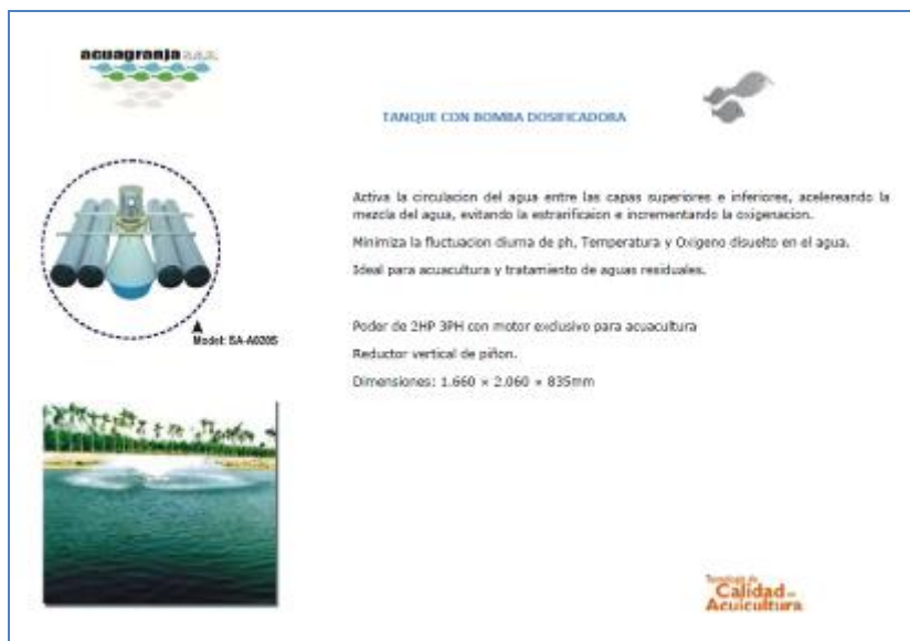
Figura 6.17. Tanque con Bomba Dosificadora
