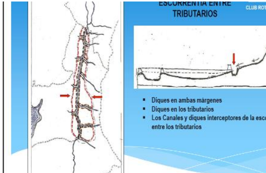
Figura 1.14. Obras de control de inundaciones
