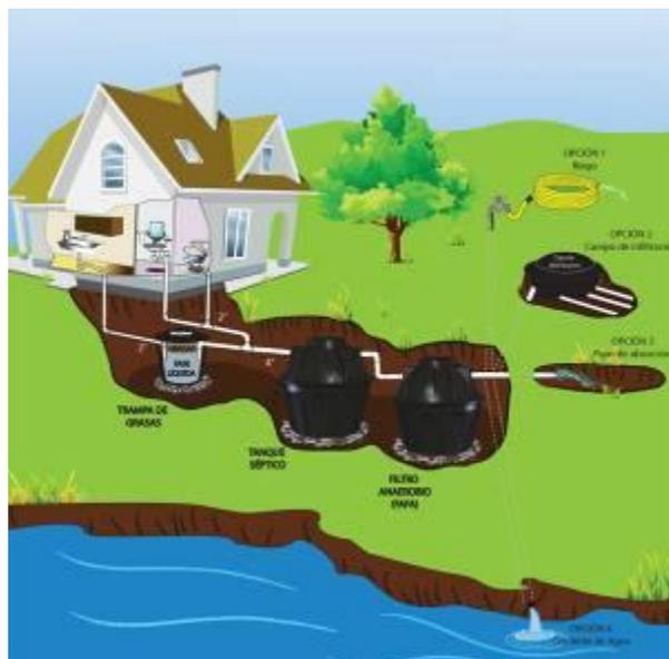
Figura 6.20. Sistema séptico prefabricado
