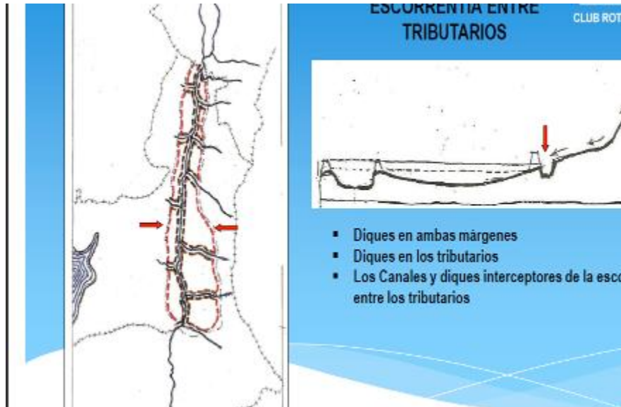
Figura 1.14. Obras de control de inundaciones
