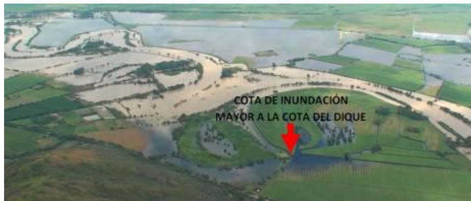
Figura 3.24. Fotografía aérea humedal La Herradura, cotas de inundación zona sur Fuente: CVC, Video inundaciones, 2010
