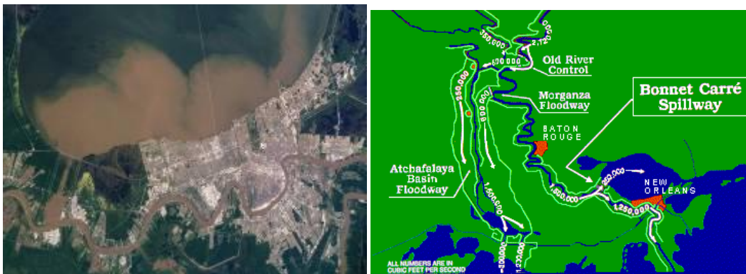
Figura 1.41. Apertura de vertederos realizada por el Cuerpo de Ingenieros de los Estados Unidos para proteger las ciudades
