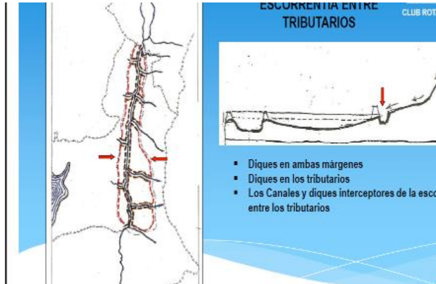
Figura 1.13. Obras de control de inundaciones
