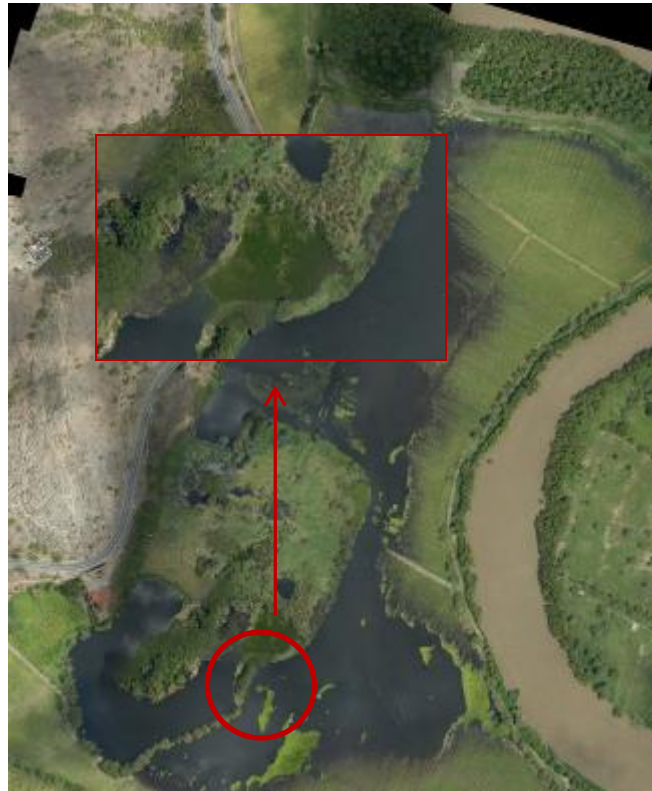
Figura 3.42. Conexión hidráulica interrumpida
