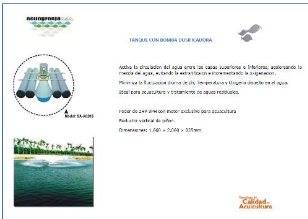
Figura 6.15. Tanque con bomba dosificadora
