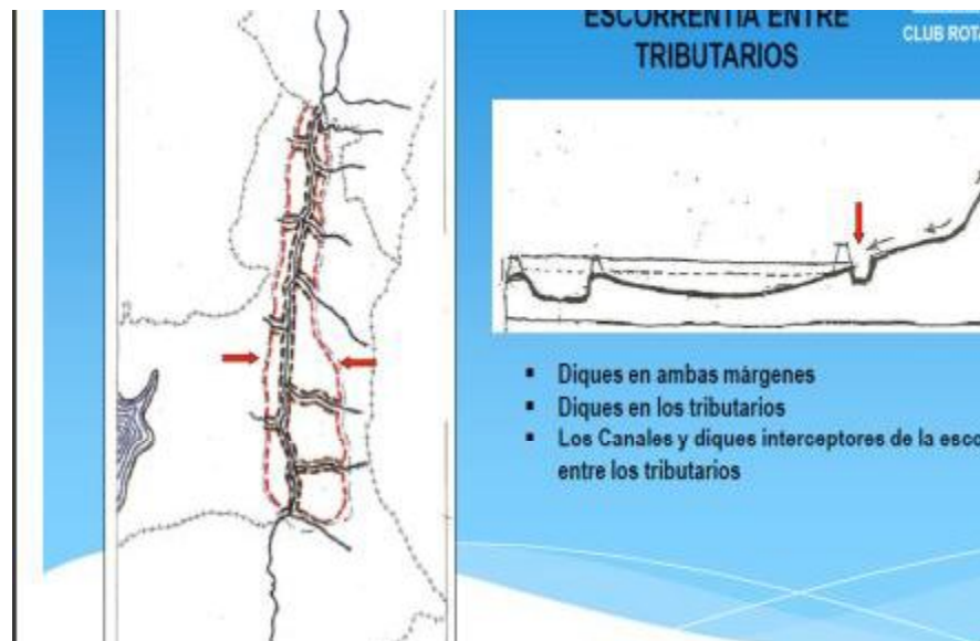
Figura 1.14. Obras de control de inundaciones
