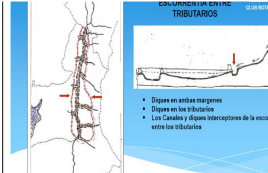
Figura 1.14. Obras de control de inundaciones
