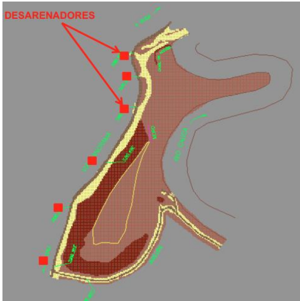
Figura 6.9. Zonificación humedal Chiquique - Manejo y tratamiento físico de las escorrentías provenientes de la vía Panorama
