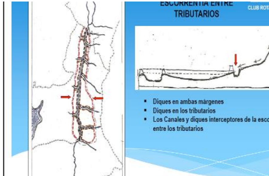
Figura 1.14. Obras de control de inundaciones
