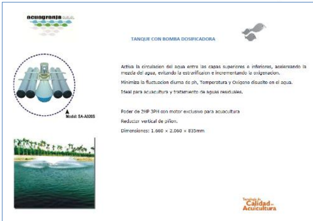
Figura 6.17. Tanque con bomba dosificadora
