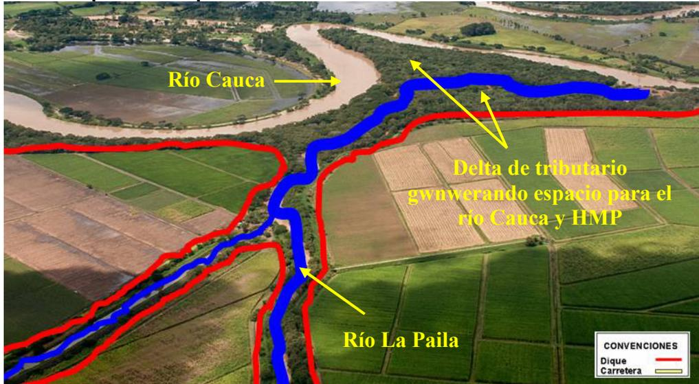
Figura 5.6 Esquema de medidas estructurales planteadas en el valle alto del río Cauca
