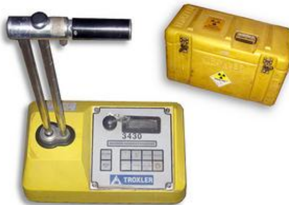
Fotografía 40. Densímetro nuclear para obtener verificaciones del grado de compactación "in situ"
