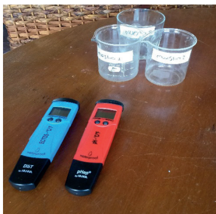
pH-metro - HANNA Waterproof Tester HI 98127(Izquierda) y el conductímetro -HANNA-Waterproof Tester HI 98312 (derecha)
