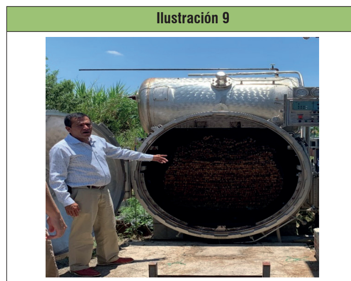
Ilustración 9: Autoclave para tratamiento de Madera y Guadua
