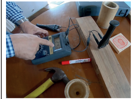
Medición del Contenido de Humedad a una viga laminada de Guadua 24,0%; se considera material semi-seco
