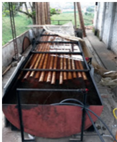
Tanque de preservación de la empresa Guadusecol SAS, sistema que usa temperatura a 60° C
