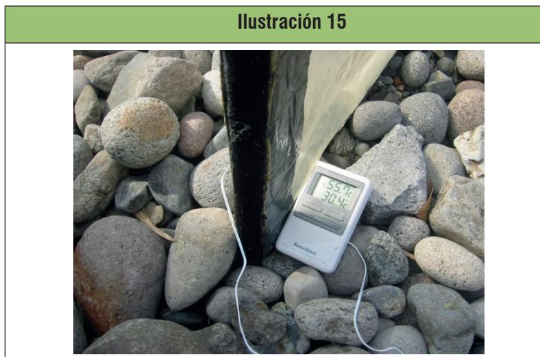
Ilustración 15: Piso en lecho de piedra, con aislamiento interno en poliuretano
