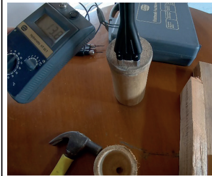
Medición del Contenido de Humedad a un tramo de Guadua 13,8%; se considera material seco
