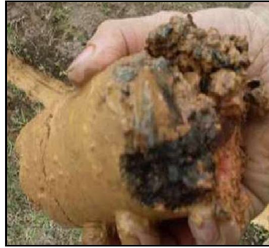
Foto 8.2 Muestra típica de material consolidado encontrado en S-3. Nótese la presencia de materia orgánica.
