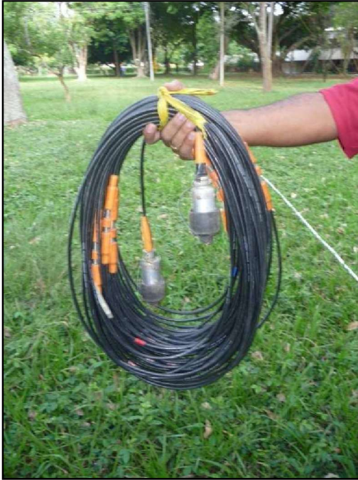
Foto 6.3 Cable de emisión.
