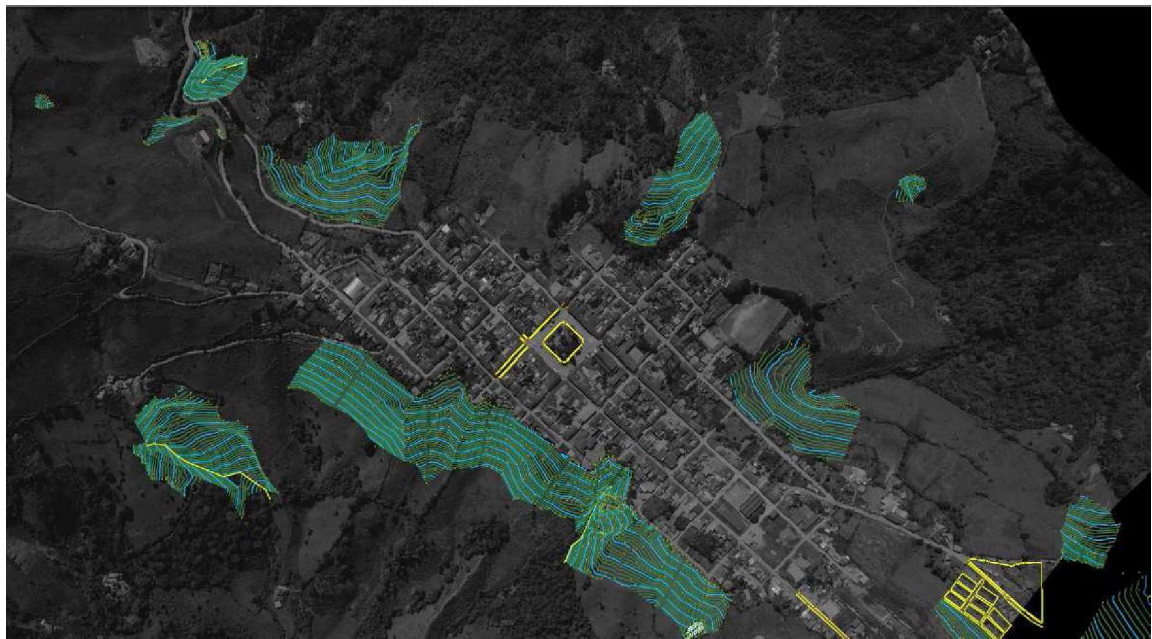
Figura 3.2 Superposición de los levantamientos topográficos en el ortofotomosaico
