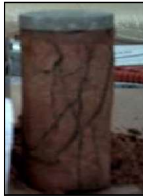
Foto 8.5 Muestra después de la falla.
