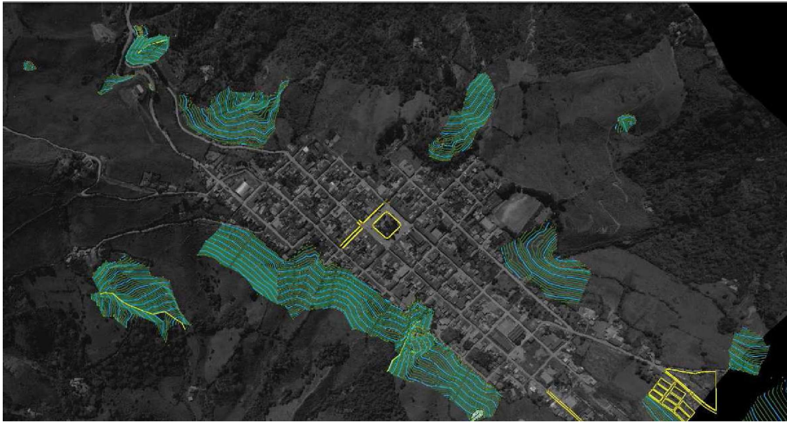
Figura 2. Superposición de los levantamientos topográficos en el ortofotomosaico
