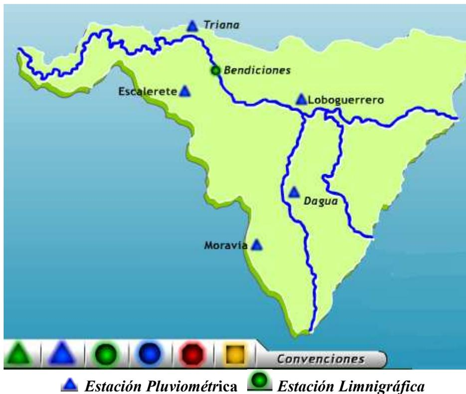
*Figura 4.4* Ubicación de las estaciones pluviométricas y limnigráficas en el municipio de Dagua.
