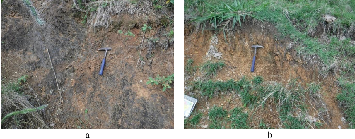
Figura 3.7. a. (T008): Basalto meteorizado y fracturado que se aprecia en la corona de un deslizamiento, parte N del Cerro la Cruz. b. (T010): Basalto meteorizado y fracturado con una tendencia de foliación de N75°E/70°NW.
