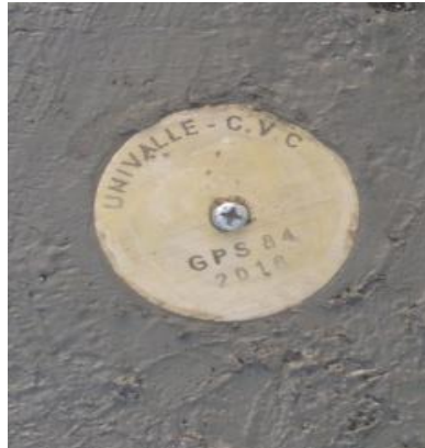
Figura 4.9. Materialización Puntos de Control Fuente: elaboración propia.
