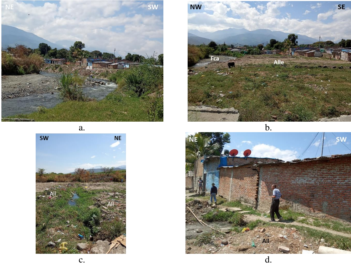
Figura 3.20. a. Llenos antrópicos mixtos que reemplazan el material de la terraza aluvial baja (Ftab) del rio Bolo, en los alrededores de la Cra 13. b. Detalle del lleno mixto con profundidad aproximada de 2m. c. Aguas servidas que circulan entre los depósitos de llenos en el sector. d. Viviendas afectadas en épocas de inundación, nótese la fractura en paredes.
