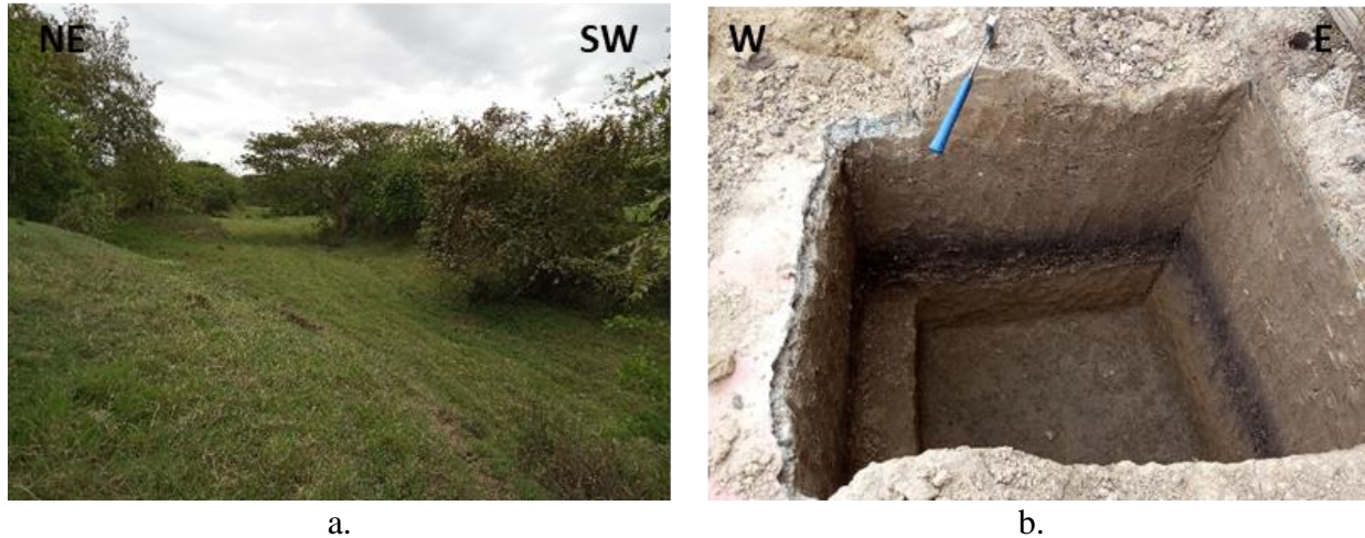
Figura 3.20. a. Evidencia de la cobertura vegetal en el cauce de la quebrada Las Jaguas. b. Apique realizado para construir las zapatas de una vivienda en el barrio Silvio Velázquez, muestra 1.3m de secuencias de depósitos aluviales de inundación.
