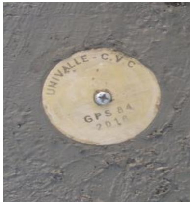
Figura 4.1. Materialización Puntos de Control Fuente: elaboración propia.
