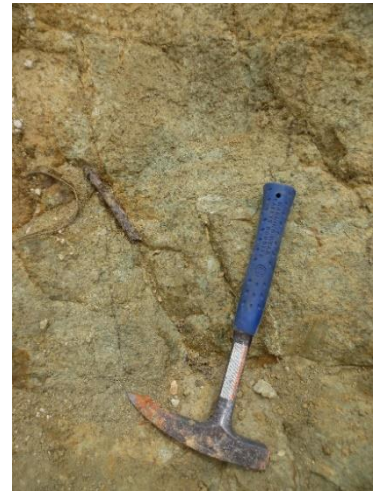
Figura 55. a. Contacto disconforme entre saprolito amarillo ocre y roca fanerítica de color gris verdoso. b. Roca fanerítica básica de color gris verdoso, fracturada y con alto grado de meteorización
