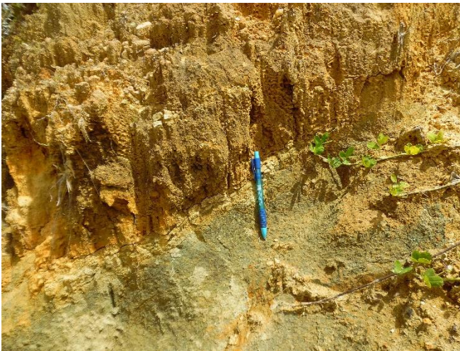
Figura 55. a. Contacto disconforme entre saprolito amarillo ocre y roca fanerítica de color gris verdoso. b. Roca fanerítica básica de color gris verdoso, fracturada y con alto grado de meteorización
