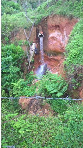
Figura 61. a. Vista E-W de saprolito expuesto por socavamiento ocasionado por la rotura de tubería de aguas negras al Norte del puente de la calle 13, sobre la quebrada Fundadores. b. Vista lateral del socavamiento
