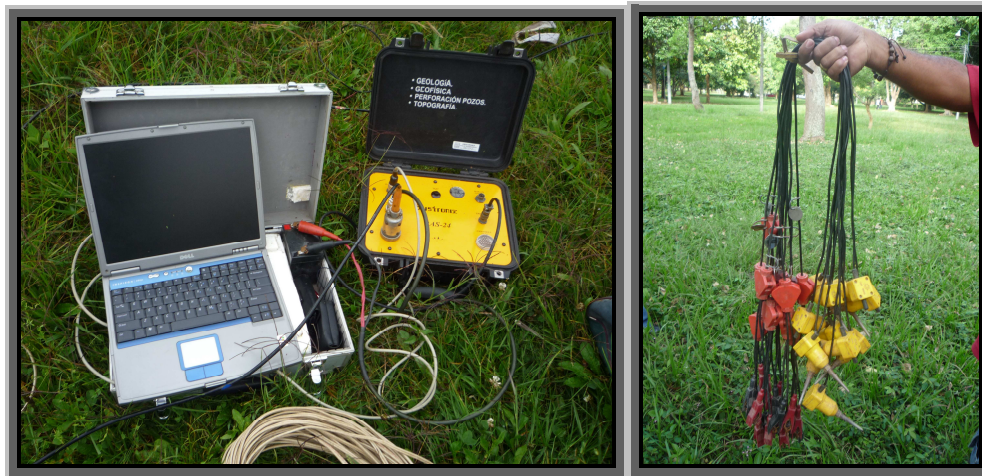
Fotos 6.1 y 6.2. Sismografo modelo Ras-24 y Geofonos para recepción de ondas.
