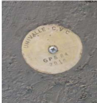
**Figura 4.1.** Materialización Puntos de Control
