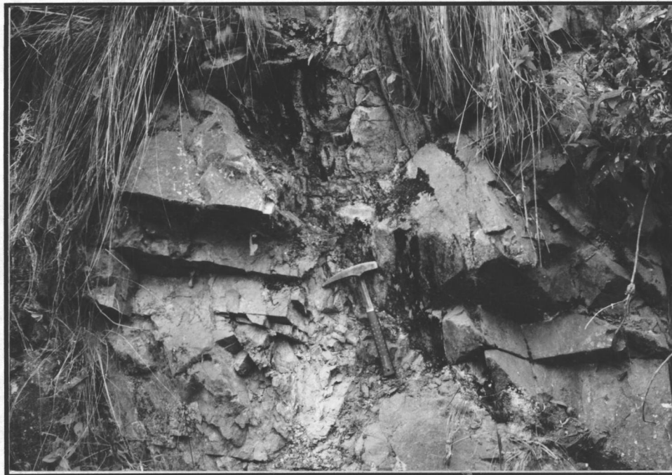
Fotografía 2.2.3. Patrón típico de diaclasamiento en bloques prismáticos y cuñas en néises anfibólicos moderadamente meteorizados. El martillo indica una zona de trituramiento dejada por el paso de la Falla de Buenavista.
