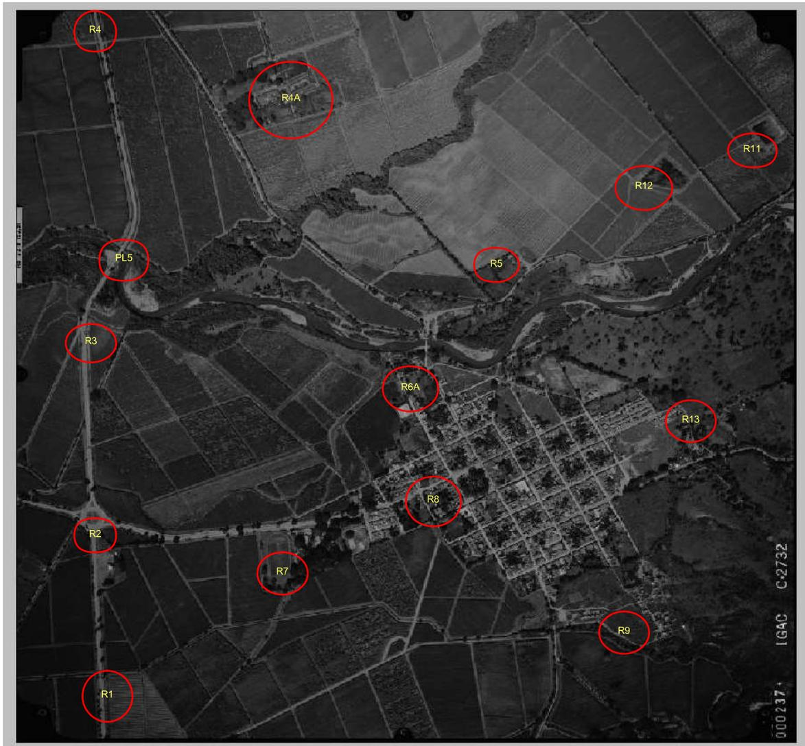
*Figura 2. Fotomosaico con la ubicación de los puntos de fotocontrol para el municipio de Riofrío.*
