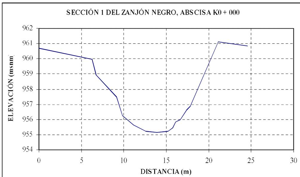
Figura 2.5 Sección transversal del zanjón Negro o Moral en la abscisa K0 + 000.
