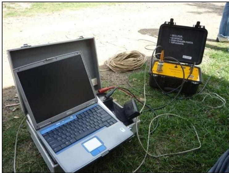
**Foto 6.1** Sismografo modelo Ras-24, para refracción sísmica.
