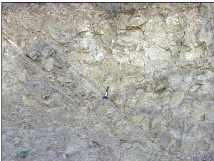
**Foto 5.1** Afloramiento de diabasa meteorizada y fracturada.
