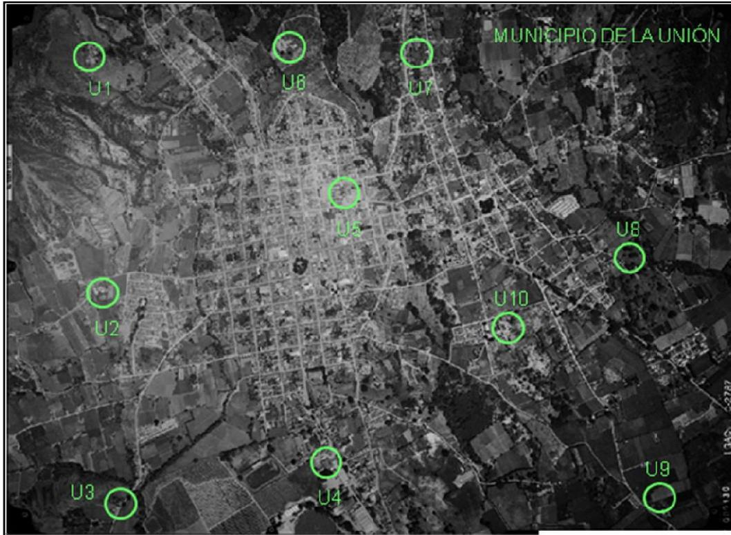
*Figura 3.5. Foto mosaico con todos los puntos de fotocontrol para el municipio de La Unión.*
