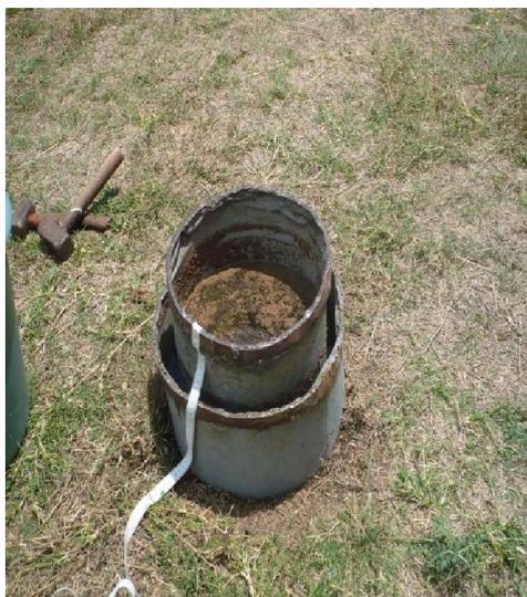
**Foto 7.14** Prueba de infiltración; barrio El Amparo.
