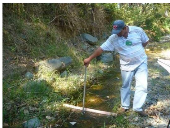
**Foto 7.15 y Foto 7.16** Aforo Quebrada La Unión.
